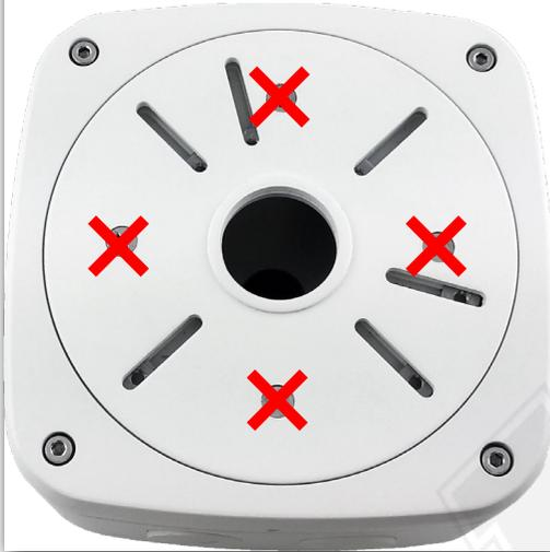
2. Lösen Sie nur die vier Innensechskant-Schrauben mit dem beiliegenden Inbus-Schlüssel.
