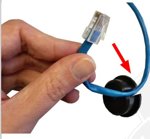
10. Setzen Sie die Dichtung mit dem innen liegenden Kabel wie hier abgebildet in die Öffnung des Deckels. Achten Sie darauf, dass der Schlitz nach unten zur kleinen Öffnung zeigt.
