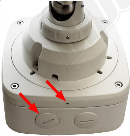
16. Schrauben Sie zuerst nur die Schraube oben rechts ein wenig ein, sodass Sie den Deckel zur Seite schwenken können, um die Kamera anzuschließen.
